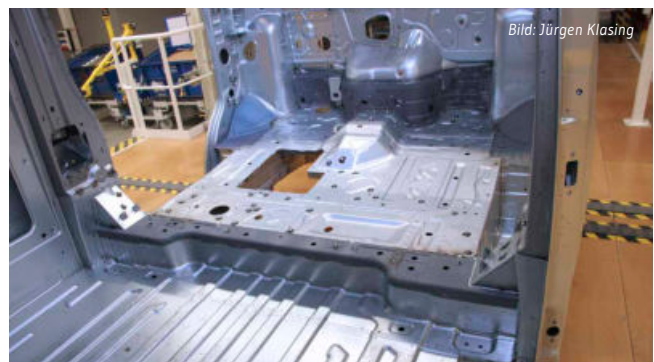
In der Fahrzeugkabine sind die warmumgeformten Bleche sichtbar: Stirnwand unten, Verbindung Boden zur A-Säule sowie die Querverstärkung zwischen den B-Säulen innen.
